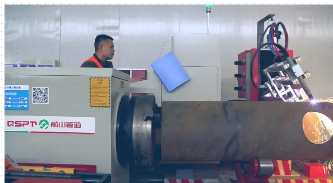
管道预制机械组对中心
