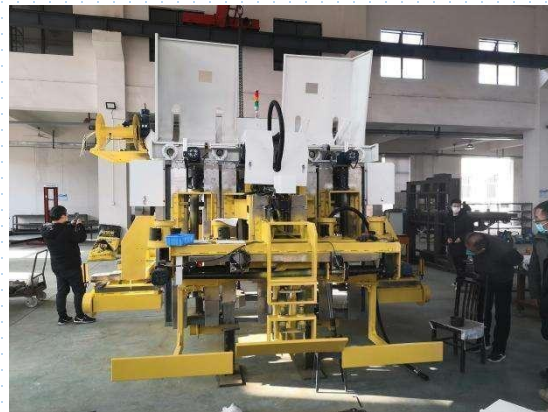
振捣机器人实物
