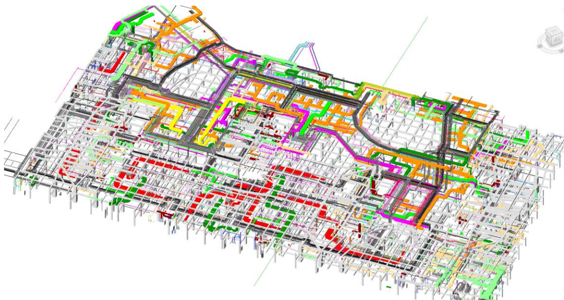
图 4.1-1 地下商业管综 BIM 模型
